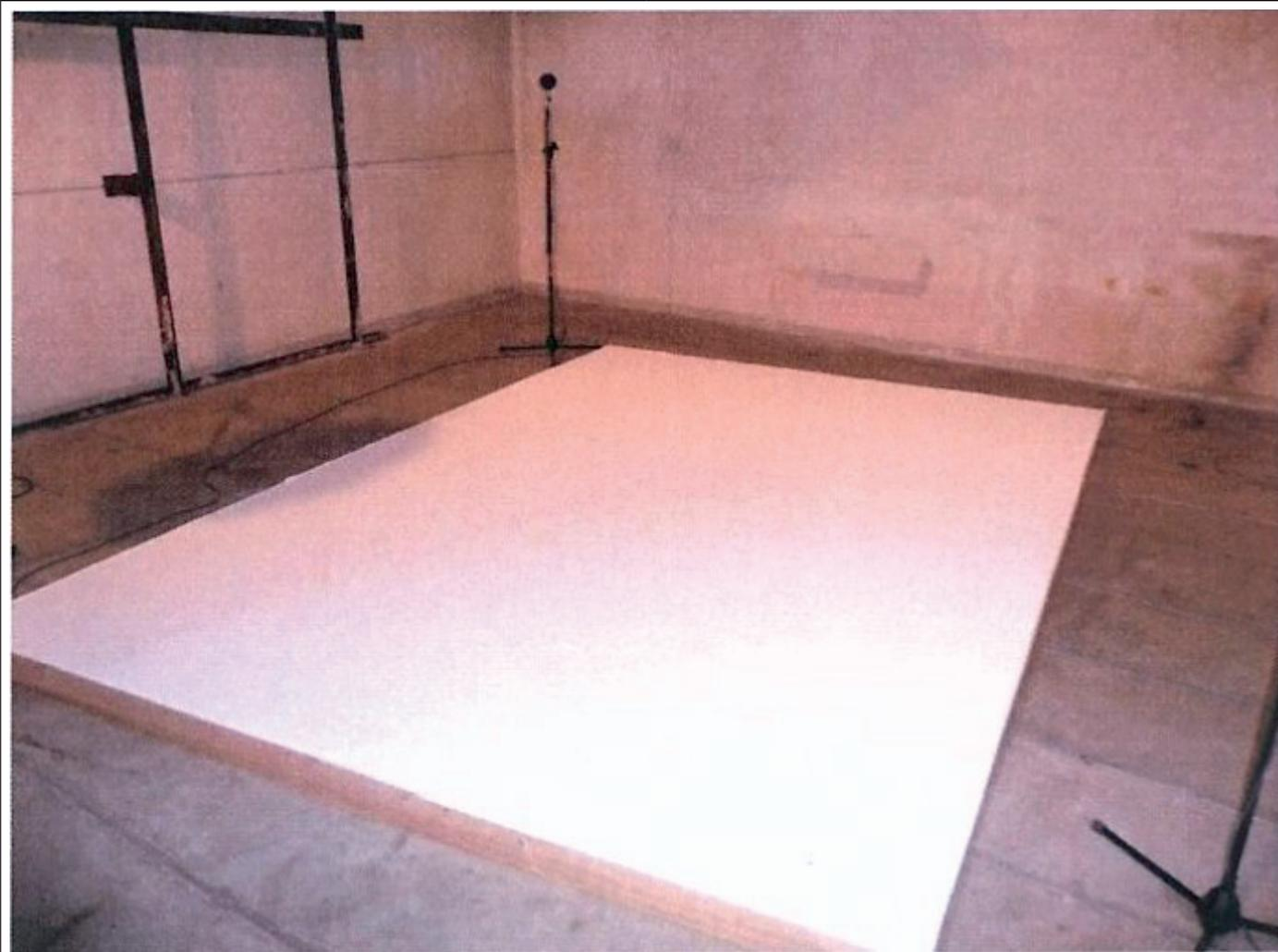
Les coefficients d'absorption acoustique ont été déterminées en chambre de réverbération : avec 110 mm d'espace total conformément à la norme DIN EN ISO 354 pour deux toiles acoustique, l'une classique l'autre imprimée.
