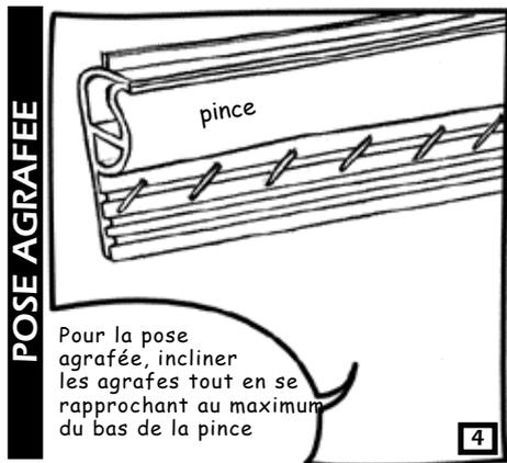
Pour la pose agrafée, incliner les agrafes tout en se rapprochant au maximum du bas de la pince
